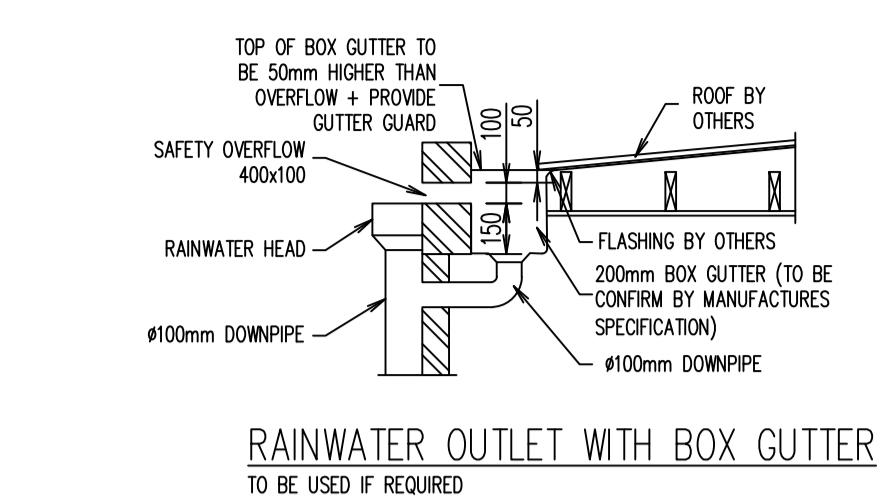
RAINWATER OUTLET WITH BOX GUTTER
